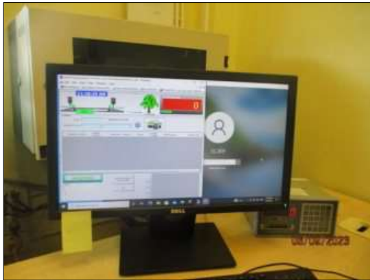
รูปที่ 2-41 คอมพิวเตอร์แสดงรายการชั่งน้ำหนัก รถบรรทุกก๊าซ NGL ก่อนและหลังการ Load ผลลัพธ์ NGL เพื่อควบคุมน้ำหนักรถให้อยู่ในเกณฑ์ ที่กฎหมายกำหนด
